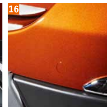
16| Датчики парковки, задние. Со звуковой индикацией. Сенсоры могут быть окрашены в цвет кузова. Комплект из 4 шт. 990E0-54P53-010
