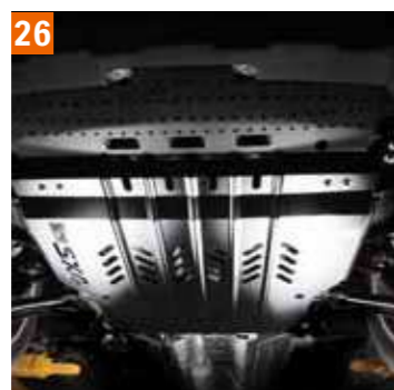
26 | Защита картера и редуктора. Предохраняет моторный отсек при наезде на высокие бордюры, заледеневшие сугробы, препятствует попаданию пыли, влаги, грязи, попыткам несанкционированного проникновения к элементам
