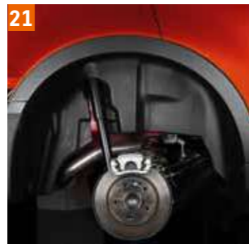
21 | Подкрылок задний. Пластиковый. Обеспечивает защиту боковых поверхностей и днища автомобиля в области колесных арок от грязи и мелких камней.
