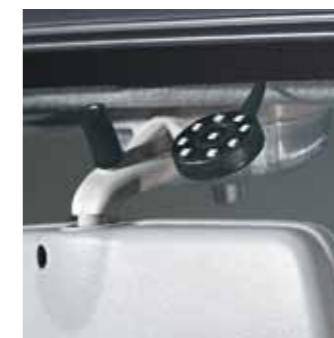
3.9 Датчик дождя. Автоматически включает дворники лобового стекла, подбирает оптимальный режим и интервал их работы. 990E0-65J81-000.
