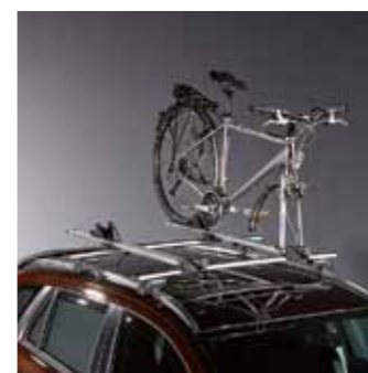
4.8 Крепление для велосипеда «Giro Speed». Для перевозки велосипеда с демонтированными передним колесом (только в сочетании с багажником 990E0-61M18-000). 990E0-59J21-000
