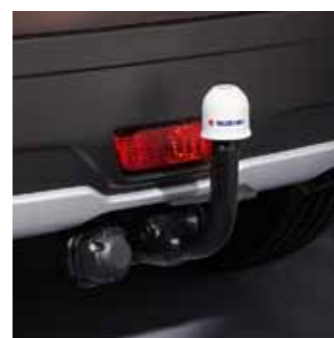
4.11 Съёмный фаркоп. Максимально допустимая нагрузка на крюк фаркопа: вертикальная — 50 кг, горизонтальная — 75 кг. Электрический разъем для подключения фонарей прицепа заказывается отдельно. Дополнительная информация указана в руководстве по эксплуатации Вашего автомобиля. 990E0-61M43-000
